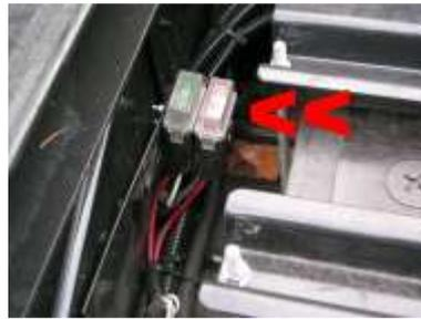
Sicherung für **Streuautomat** im Batteriekasten auf der **rechten** Seite.
